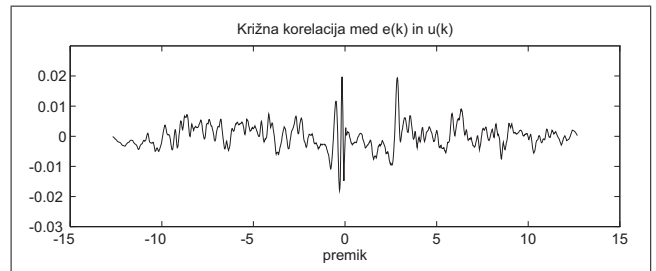
Slika 2.16: Križna korelacija med napako e(k) in vhodnim signalom u(k) za prenosno funkcijo \hat{G}_{pn}
