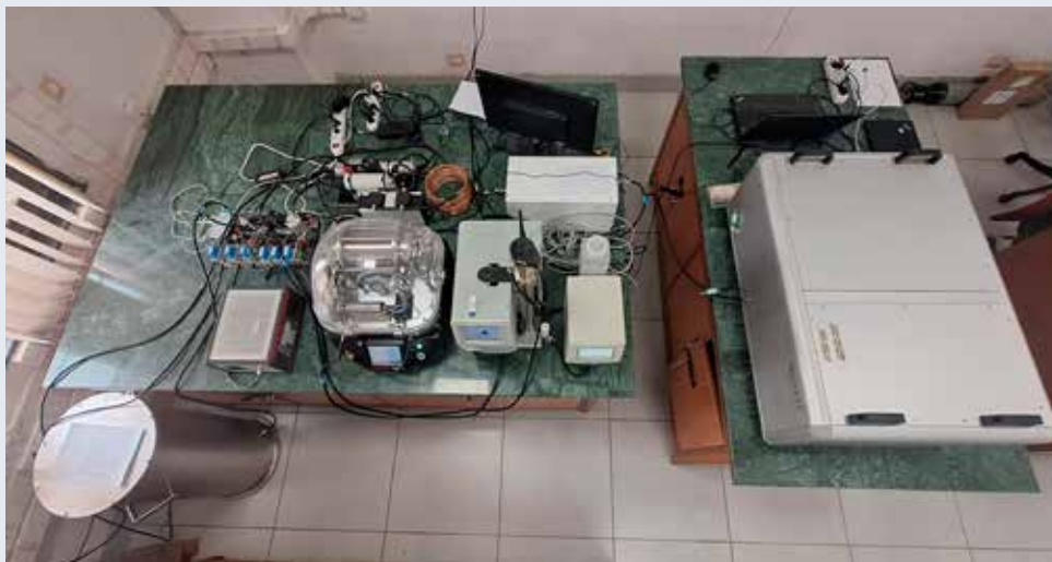
Inštrumentarij za meritve ojačanja koeficienta absorpcije aerosolov, ko se ti oplaščijo z organskimi snovmi – Sonipat, Indija.
