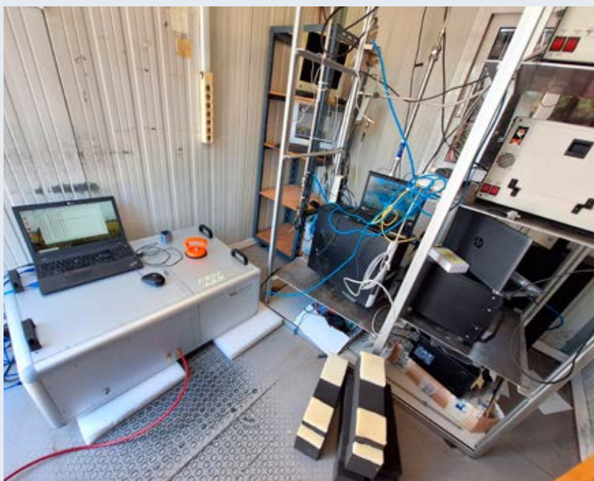
Terenske meritve absorpcijskega koeficienta aerosolov v Atenah, Gričija - levo spodaj inštrument slovenskega proizvajalca Haze Instruments d.o.o..
