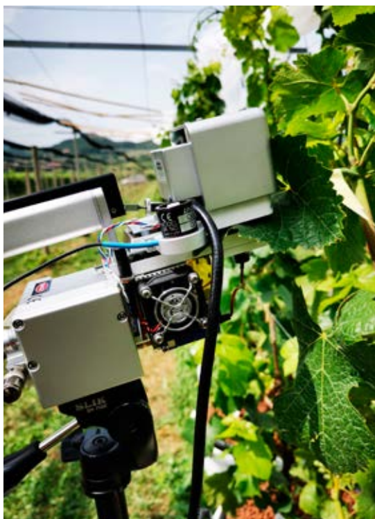
Meritev fotosintezne aktivnosti in prevodnosti listnih rež lista vinske trte z infrardečim analizatorjem plinov (v sodelovanju s Kmetijskim Inštitutom Slovenije).
