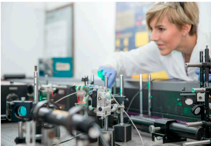
Mlada raziskovalka pri delu z optotermičnim spektrometrom zgrajenem v Laboratoriju za vede o okolju in življenju.
