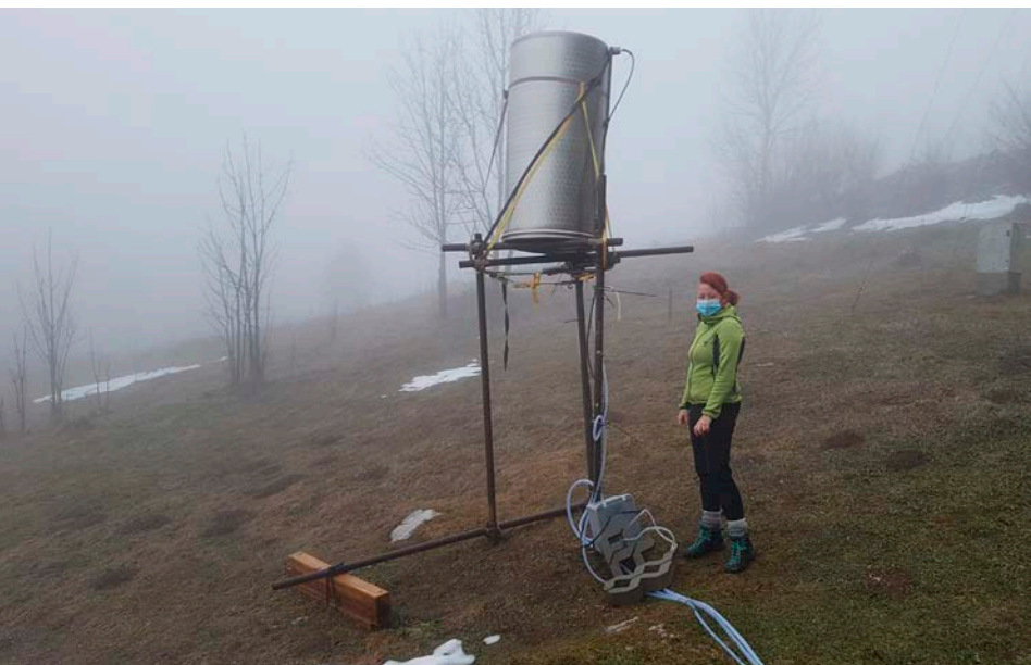
Meritve aerosolov, kapljic vode in kristalov ledu v oblakih na observatoriju Otlica.
